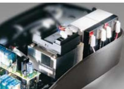
**Une efficacité optimale.** Un automatisme en 24 V DC qui ouvre toujours votre garage, même en cas de panne, grâce aux batteries de secours internes (en option).
