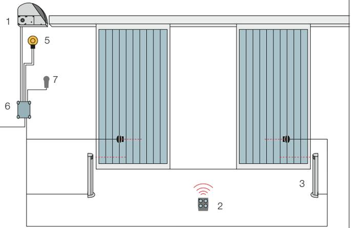
1. Sumo 2. Emetteur 3. Photocellules sur colonne 4. Photocellules 5. Lampe clignotante 6. Logique de commande 7. Sélecteur à clé ou à code.
